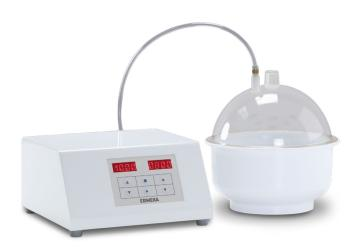
Der ERWEKA VDT/S ist ein Vakuum Dichtigkeistester für Blister und andere Verpackungsformen. Mit seiner kompakten Größe ist der VDT/S ideal für die Qualitätskontrolle während des Verpackungs- und Abfüllprozesses geeignet. Das Gerät besteht aus zwei miteinander verbundenen Einheiten - der Hauptsteuereinheit mit integrierter Vakuumpumpe und dem Vakuumbehälter.
