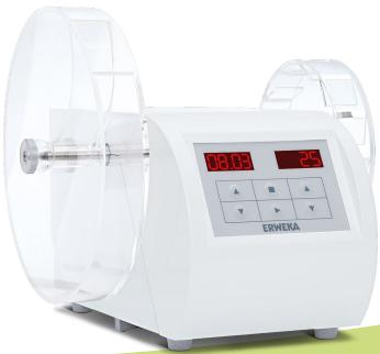
Die ERWEKA TAR Serie testet die Friabilität und den Abrieb von Tabletten gemäß den USP/EP/JP Richtlinien.
